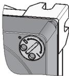
Abb. 4: Belüftung geschlossen
