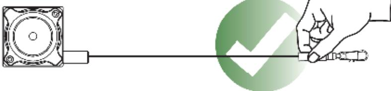
Das Seil muss im Betrieb senkrecht aus dem Sensor ausgezogen werden.
